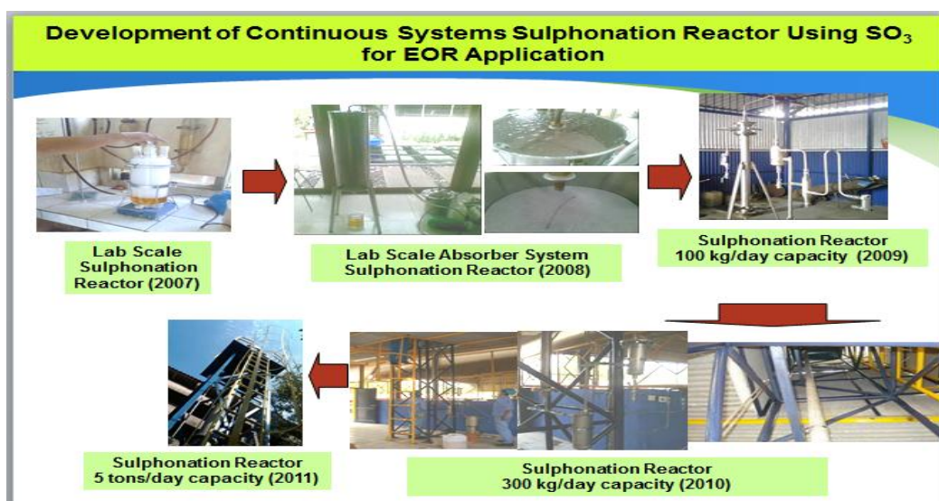
Gambar 1. Perkembangan reaktor sulfonasi untuk produksi surfaktan MES menggunakan reaktan gas SO_3 untuk aplikasi EOR/IOR
